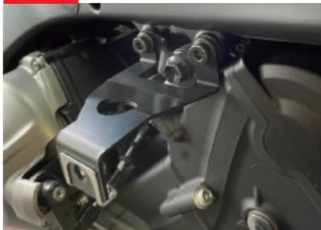
締め付けトルク：25Nm
