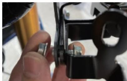
下側の2箇所は、キットに付属のボルトナットを使用します。
