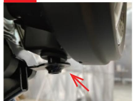
ヘッドライトを3cmほど上に持ち上げて、下部のマウントから引き抜く。後ろに配線がついているので10cm以上引っ張らないように注意して下さい。
