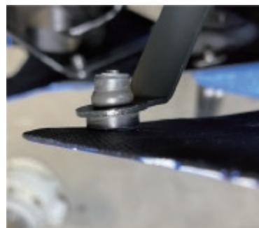
ウェルナットの適切な締め込み具合。
