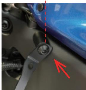
参考締め付けトルク：8Nm
