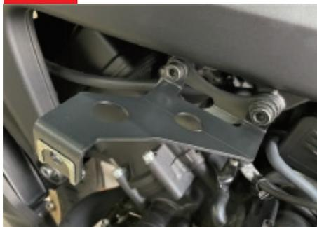
締め付けトルク：25Nm
