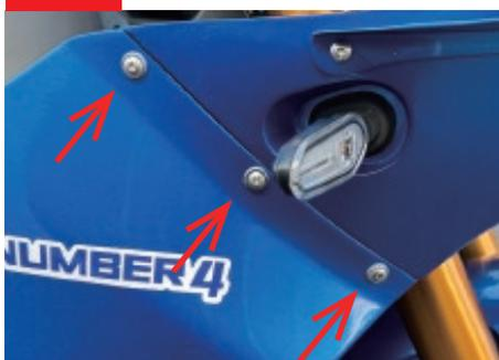
アッパーカウルと、ヘッドライトのセンターが合うように調整をしながら、アッパーカウルとサイドカウルを接続するウェルナットを締め込みます。
