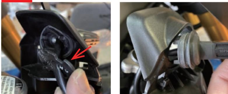
ウインカー本体の裏側のロック板を外し、内側を手で押さえつつ、外側からウインカー本体を引き抜きます。
