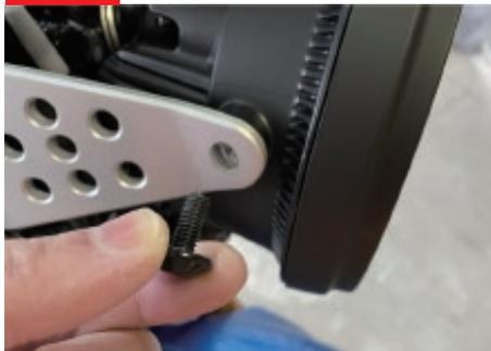
ヘッドライト左右の固定ボルトを外す。
