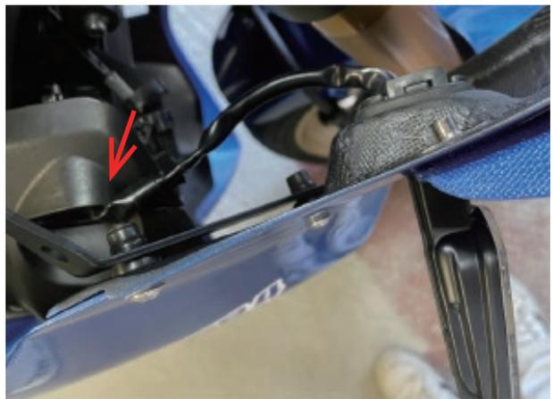
配線はこのような経路でノーマルのウインカー固定部の穴を通してカプラーと連結します。
