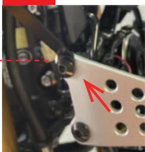
参考締め付けトルク：6Nm
